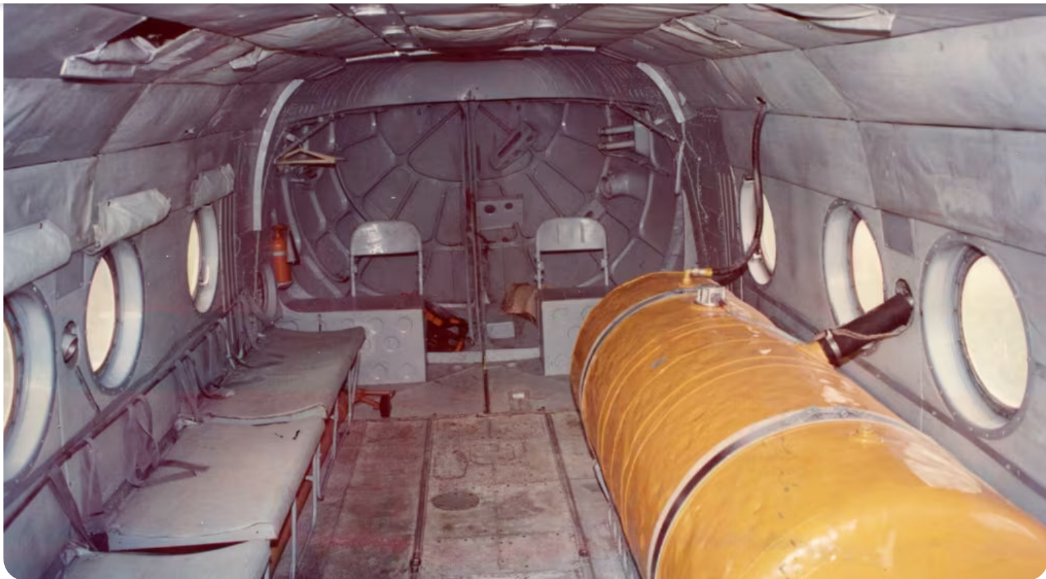
El tanque de color naranja era desmontable y se utilizaba como tanque extra de combustible para viajes más largos. Las dos sillas en el fondo son los inodoros
